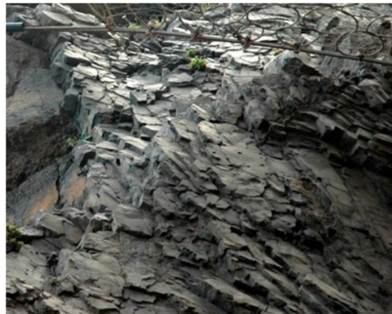
Figura II.4. Ejemplos de grados de fracturación. A la derecha macizo moderadamente fracturado, a la izquierda muy fracturado.
