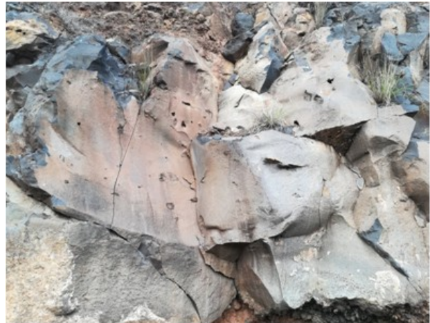
Figura II.3. Ejemplos de grados de fracturación. A la derecha macizo masivo, a la izquierda poco fracturado.
